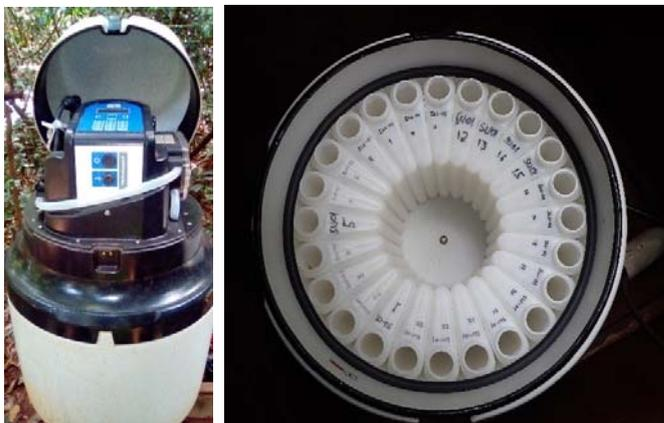
Figure 16 : Echantillonneur automatique
