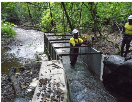
Figure 17 : mesure de débit à SW09
